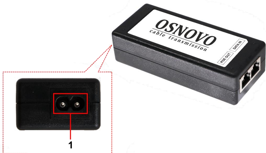
Рис. 3 Midspan-1/300G, Midspan-1/300GA, разъемы задней панели
